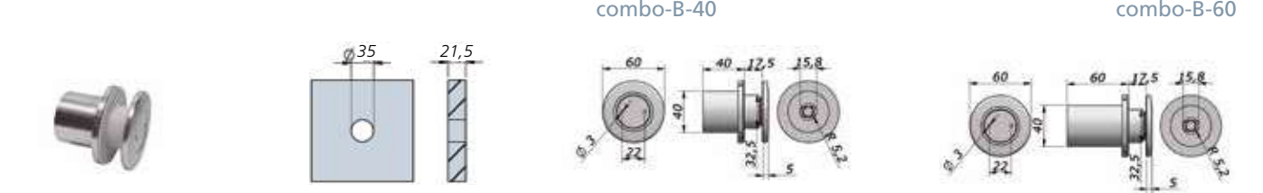
Vite di fissaggio a muro con distanziale regolabile h 40/60 borchia piatta diam. 60 Adjustable fixing screw with flat ring diam. 60, spacer h. 40/60
